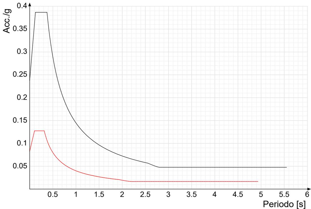
Vengono confrontati lo spettro Spettro di risposta di progetto in accelerazione della componente verticale SLD § 3.2.3.5 (di colore rosso) e Spettro di risposta di progetto in accelerazione della componente verticale SLV § 3.2.3.5 (di colore nero).
